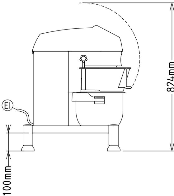
EI = Conexión eléctrica (energía)
